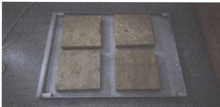
Рисунок 8 – Зволоження дослідних зразків теплоізоляційного матеріалу марки «ТЕХНОВЕНТ ЕКСТРА»
